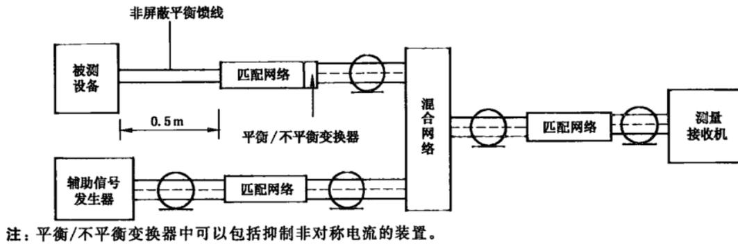
图 8 平衡天线端骚扰电压测量布置(见 5.4.3)
