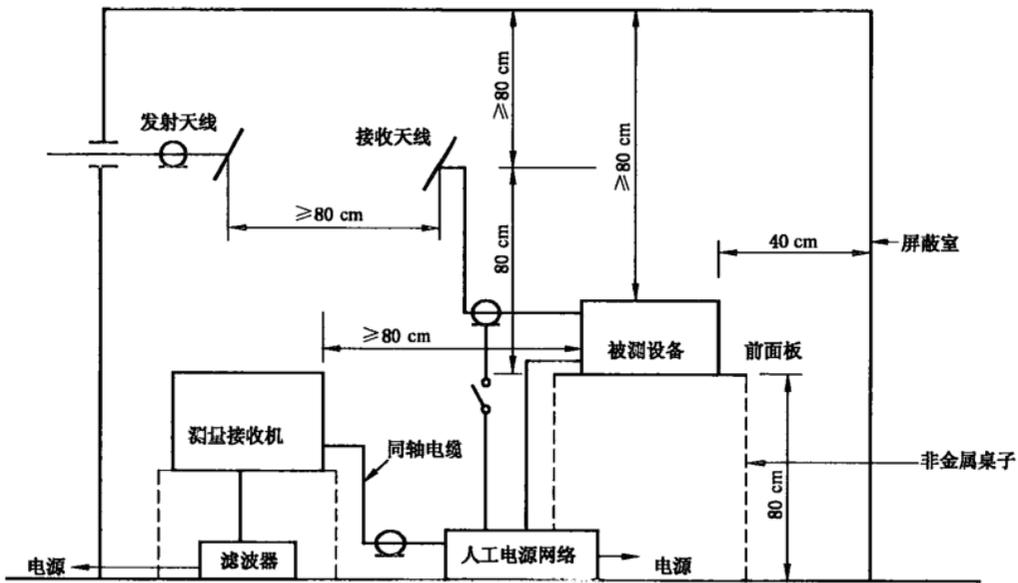
图 5 电源端射频骚扰电压的测量(见 5.3.1)
