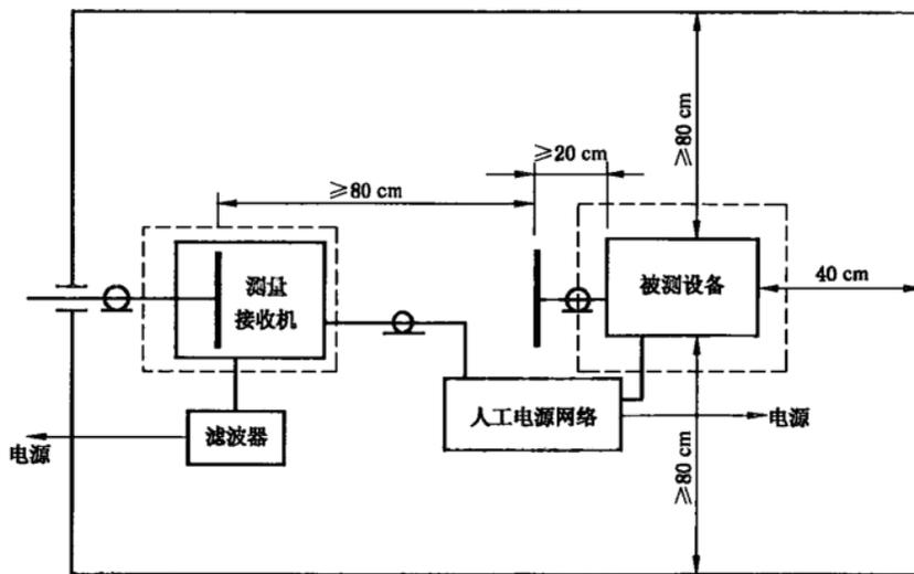
图 6 电源端射频骚扰电压的测量(俯视图)(见 5.3.1)
