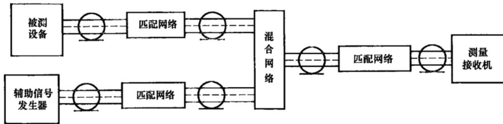
图 7 同轴天线端骚扰电压测量布置(见 5.4.2)
