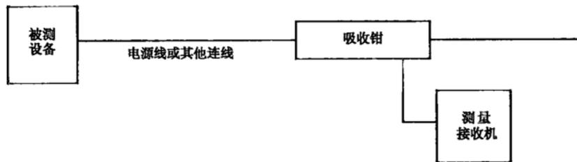
图 10 有关设备骚扰功率测量原理图(见 5.6.3)
